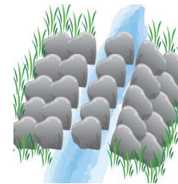
Schéma de principe d'un gué enroché
